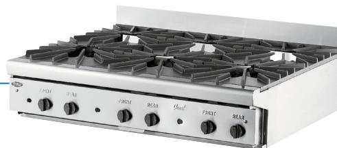
**Module Feux Ouverts** Disponible en multiples de deux feux de 12" (305mm) ou de 18" (457mm). Feux puissants ouverts en étoile de 9" (229mm) de diamètre avec 26,000 ou 30,000 BTU dégagent plus de chaleur sur une plus grande surface, parfait pour bouillir et/ou sauter. Le caisson et la structure entièrement soudés augmentent la durabilité et éliminent la corrosion. La grille de fonte robuste améliore la performance des brûleurs. Grilles linéaires en acier inoxydable disponible en option.
